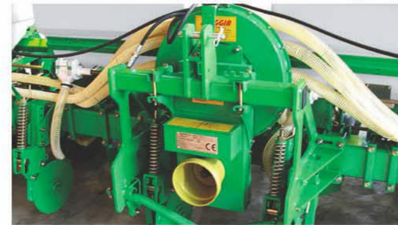
Трехточечное соединение II и III категории с рычагом быстрой сцепки. Трехточечное соединение III категории предназначено для больших машин.
